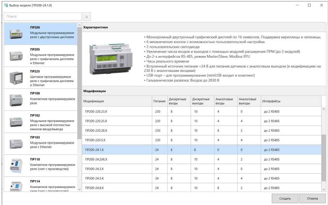
Рисунок 4.2 – Окно выбора прибора
